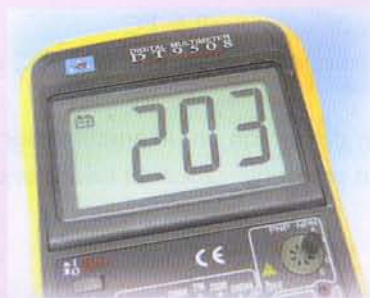
c. Midiendo el \beta estático ( h_{FE} ) del transistor
